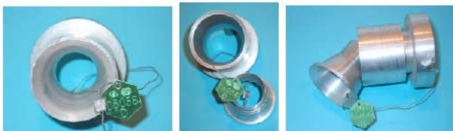
À vista desarmada parece normal, um pouco mal feita a união do cilindro interior com o exterior, nota-se um pequeno sulco; depois de se retirar e selar, foi levada para uma oficina e com uma ferramenta conseguiu-se separar os dois corpos. “O concorrente ficou sem licença desportiva durante um tempo, sanção imposta pela FIA
