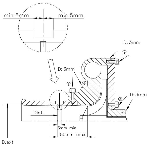
Este diâmetro deverá ser respeitado quaisquer que sejam as condições de temperatura.
